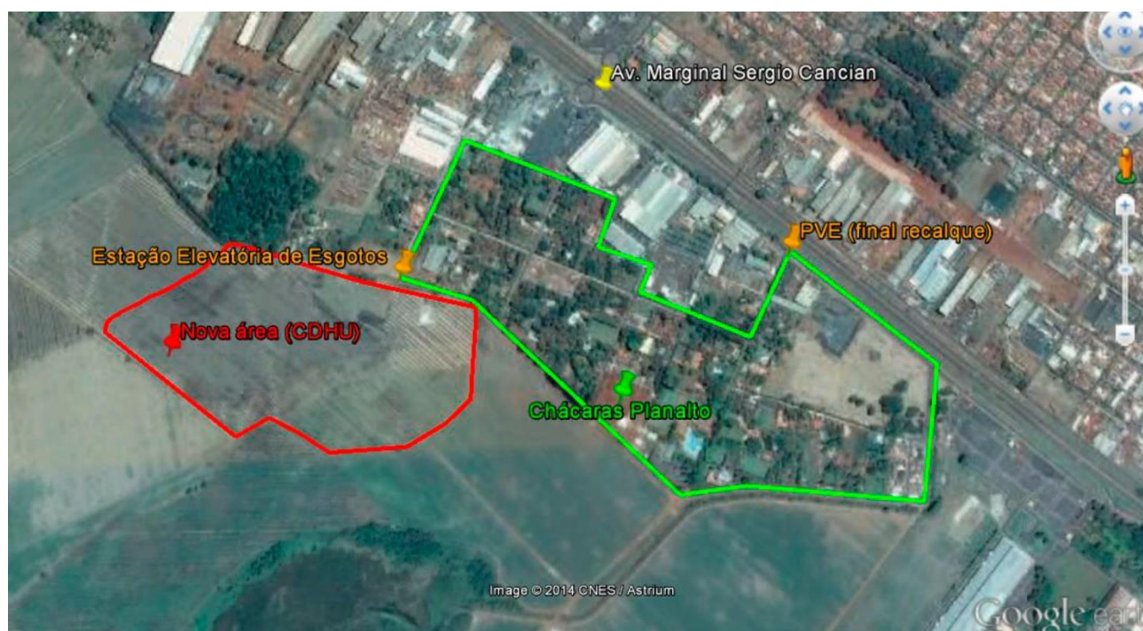
Figura 2. Imagens dos Loteamentos em desenvolvimento, da EEEB Chácara Planalto onde está locada atualmente (em projeto) e do PV existente de onde o esgoto seguirá por gravidade até a ETE.
